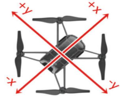
미션패드를 이용할 경우 텔로에듀의 방향과 관계없이 미션패드의 좌표를 기준으로 텔로에듀가 이동합니다. 가운데에 미션패드 번호가 적혀있고, 로켓의 방향과 수평인 선이 x축입니다. 즉 로켓이 날아가는 방향이 x축, 수직이 y축, 높이가 z축입니다.
