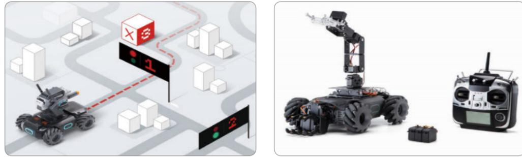
기본적으로 제공되는 기능만 활용해도 선(Line) 인식과 비전 마커 인식, 사람 인식 및 동체 추적이 가능하고 타겟 인식되어진 사물 따라가기, 동작 인식, 전투 상대 인식 등을 지원하며, 설명서의 비전 마커와 간단한 프로그래밍 조작 및 자율 주행도 수행할 수 있게 해줍니다. 애플리케이션을 이용하면 실시간 전투와 레이싱 경기도 가능하니, 코딩 수업이 아니라도 다양한 방식으로 학교 현장에서 수업에 활용할 수 있습니다.
