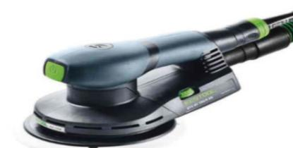
전동샌더는 모터의 회전력을 이용한 전동공구로 벨크로 형태의 탈부착용 사포를 부착하여 목재의 표면을 매끄럽게 다듬거나 갈아내는 용도로 사용한다. 형태에 따라 원형, 사각, 삼각 샌더가 있다. 전동샌더를 사용할 경우에도 나뭇결의 방향을 보고 결과 평행하게 고른 압력으로 샌딩을 해야 작업의 결과가 좋다.
