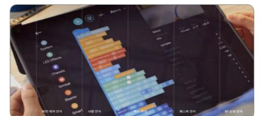
DJI 로보마스터 S1은 블록 기반 프로그래밍 언어인 스크래치(Scratch) 3.0, 인터프리터 방식의 파이썬(Python)을 기반으로 되어 있으며 펌웨어 업데이트를 통해 C/C++ 코딩 언어도 지원할 예정이라고 합니다. PWM 포트 6개와 Sbus 포트를 사용해 맞춤 액세서리를 적용할 수 있고, 원하면 외부 개발 보드를 이용해 더 복잡한 코드로 자신만의 기기로 창조해낼 수도 있습니다.
